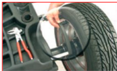
Automatyczny pomiar odległości i średnicy.
